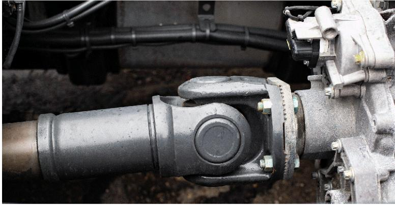
**Figura 7.2:** Detalhe de uma das duas juntas de um eixo cardan de caminhão, que transmite potência da caixa de câmbio ao diferencial.
