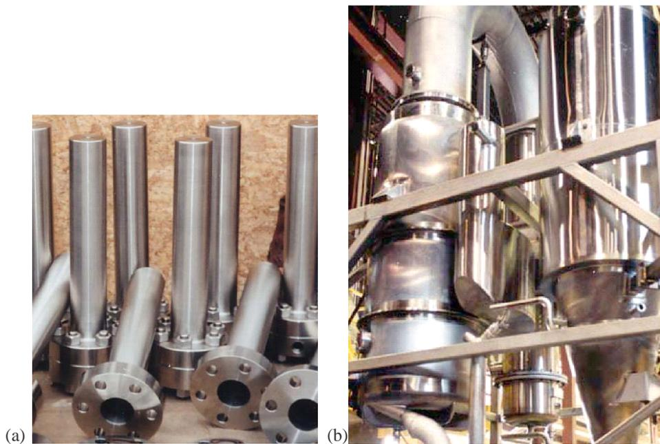
**Figura 6.18:** (a) Tubos de aço com flange; (b) parte de instalação industrial com tubulações e vasos de pressão.
